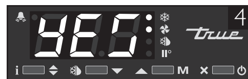
Рис. 4: Если появился символ «yes», контроллер заблокирован.
