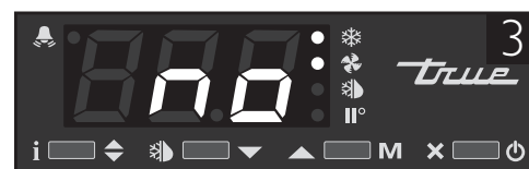
Рис. 3: Если появился символ «no», контроллер разблокирован.
